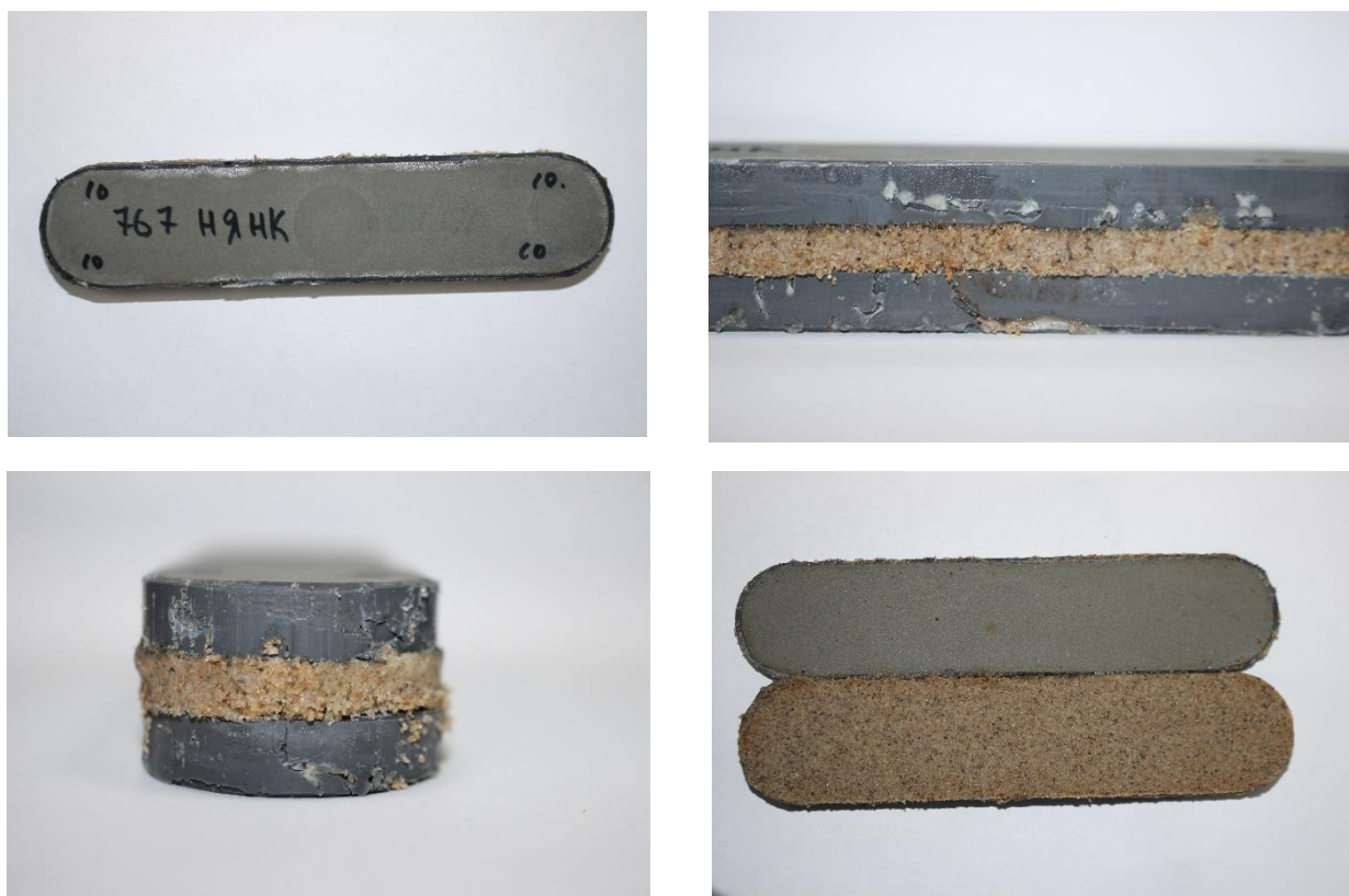
Рисунок 5 – Проба пропанта для измерения сферичности и округлости
