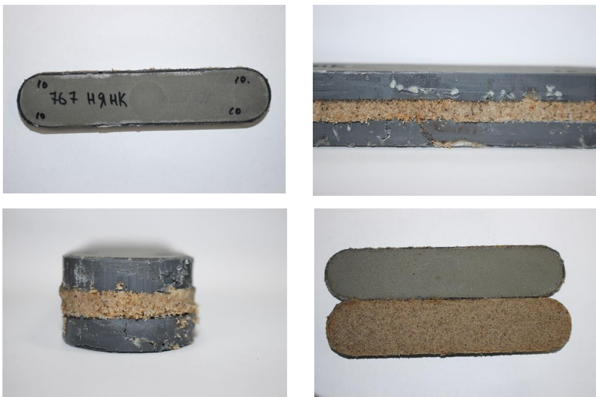
Рисунок 5 – Проба пропанта для измерения сферичности и округлости
